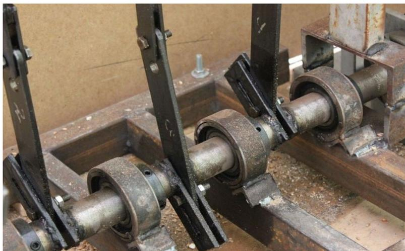
*Рис. 12: Узел регулировки амплитуды колебаний смесительной камеры.*
