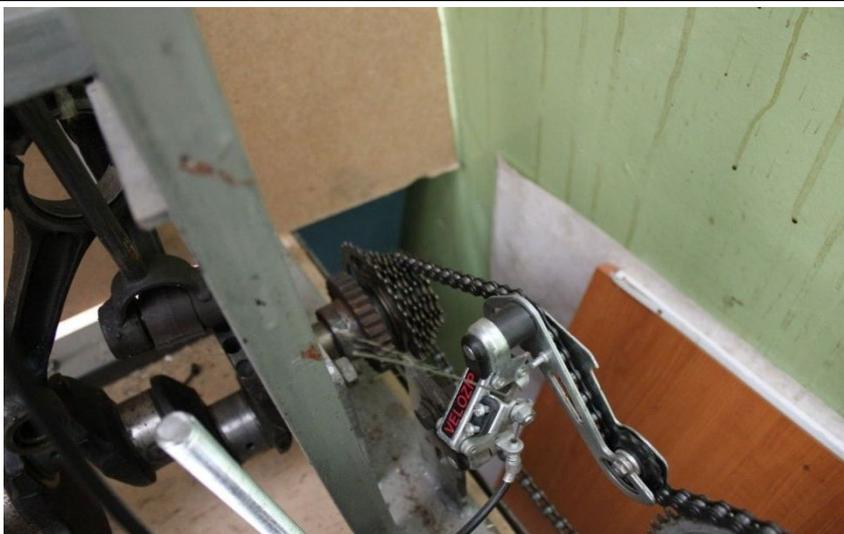
*Рис. 11: Узел регулировки частоты колебаний отсеков смесительной камеры.*
